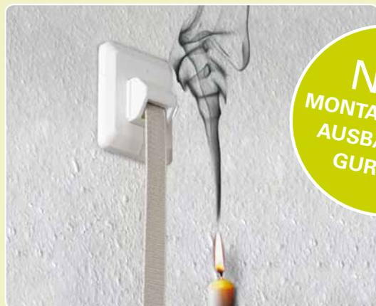
Nach der Gurtsanierung: < 0,04 m<sup>3</sup> Luft / Std. = Referenzdurchlässigkeit Klasse 2 Q10 bei 10 Pa
